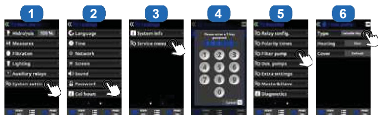
Diagram över installation av pump med variabel hastighet på AquaRite® HC LS
